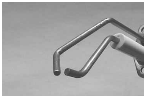
Figuur 9 Afstelling ontsteek elektrode
